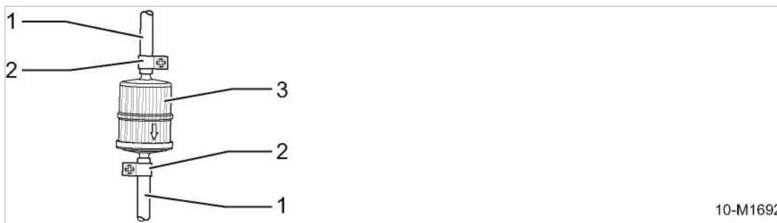
Att. 25 Degvielas priekšfiltra apkope
